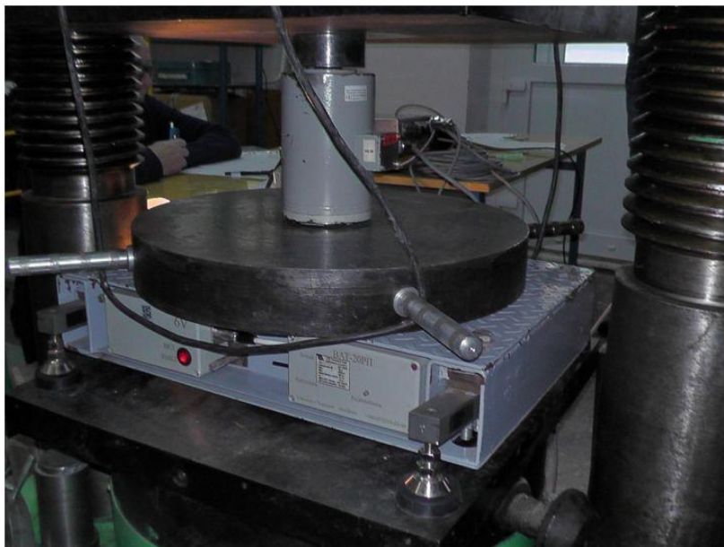
Рис. 2 – Метрологічні випробування платформи авіаційних ваг типу ВАТ на гідравлічному пресі з еталонним датчиком сили СЗНЗ/20t
