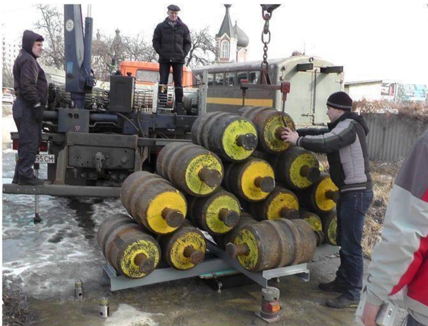
Рис. 1 – Навантаження еталонних гир 500 кг на платформу авіаційних ваг типу ВАТ
